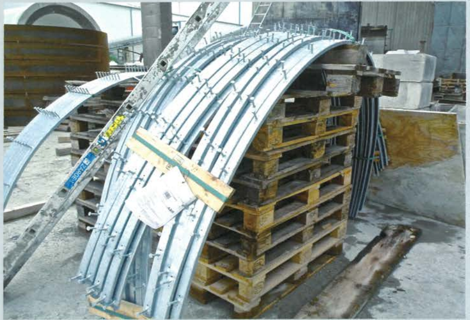
Ringförmig gebogene und gezahnte Schienenprofile in Verbindung mit vormontierten Verbindungsteilen wurden bereits im Fertigteilwerk einbetoniert.
