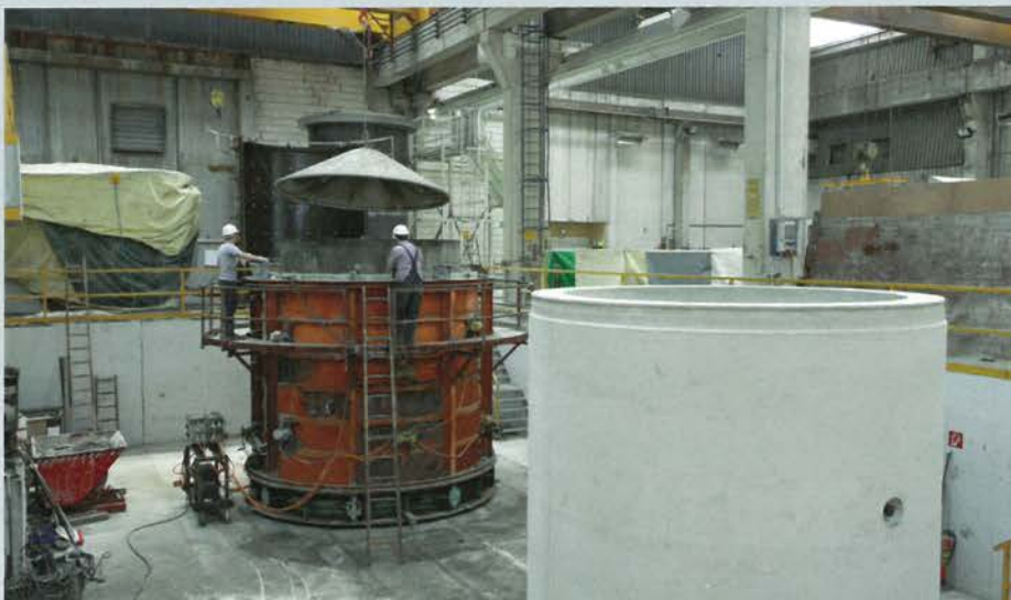
Die Hochleistungs-Stahlbetonrohre werden im Einzelrüttelverfahren in stehenden Stahlschalungen hergestellt.
